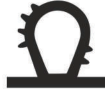
* HM 12-10 Cam Kanal Contası (WC 11-03) Glass Channel Gasket (WC 11-03)
